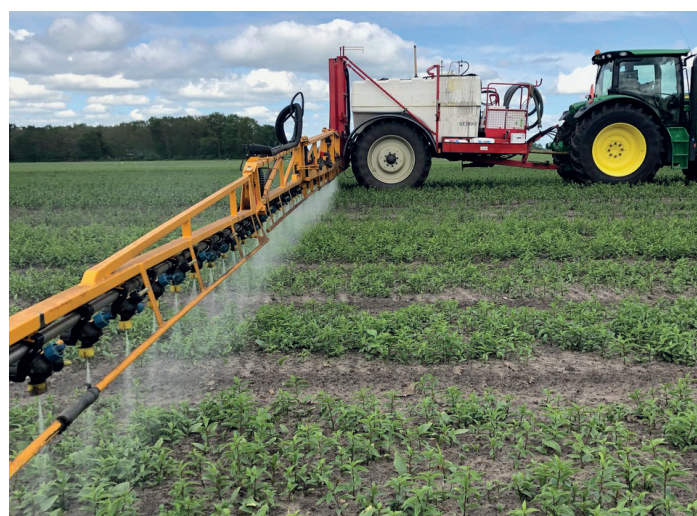
Verlaagde spuitboom in de lelieteelt, Drenthe (Foto: Fernhout BV)
