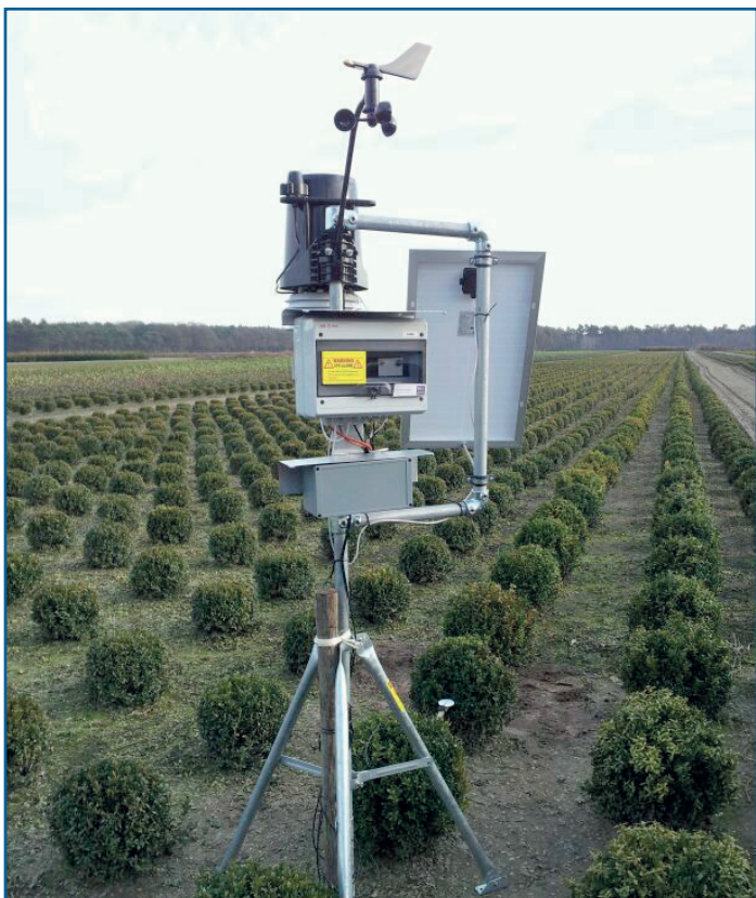
Een weerpaal meet de weersomstandigheden (onder andere temperatuur, luchtvochtigheid en windsnelheid) op het perceel of tussen het gewas. (Foto: Delphy)
